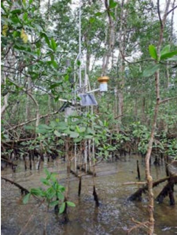
**Figura 12. Estação Meteorológica Automática instalada no manguezal do Parque Estadual Ilha do Cardoso**
